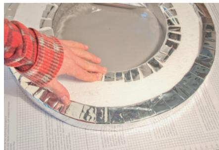
2. Zunächst die Seitenfläche des Umfangs mit einem 10 cm breiten Streifen Klebefolie be-ziehen, die überstehenden Kanten einschnei-den und nach beiden Seiten innen und außen umlegen.
