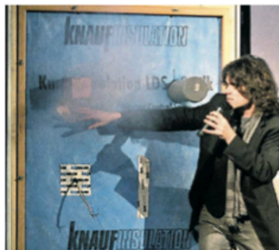
Schwachstellen-Analyse: Beim „Blower-Door-Test“ genügen Ventilator und Nebel, um festzustellen, an welchen Stellen im Haus „teuer bezahlte Wärme“ entweicht. (Fotos: aw)
