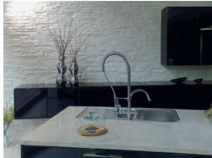
Dünne Platten mit großartiger Wirkung: Die nur wenige Millimeter dünnen Paneele aus glasfaserverstärktem Kunststoff werden einfach an die Wand geschraubt.
