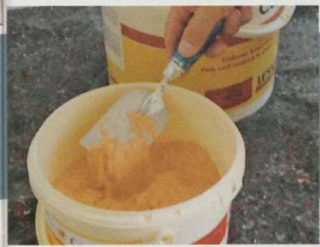
7 Lehm ist Bindemittel und Farbgeber in einem Material.
