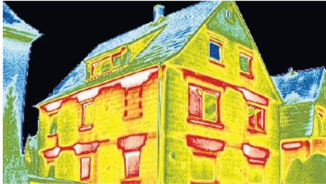
Zu den Aufgaben eines Energieberaters gehört die Schwachstellenanalyse mit einer Thermografiekamera: Die Farben „Gelb“ und „Rot“ signalisieren hohe Energieverluste, „Blau“ sagt „alles Okay“.
