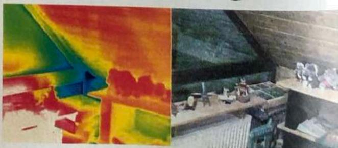
**4. Schwachpunkt:** An Fenstern und Balkontüren im Obergeschoss dringt Kälte ein, Feuchtigkeitsschäden drohen.
